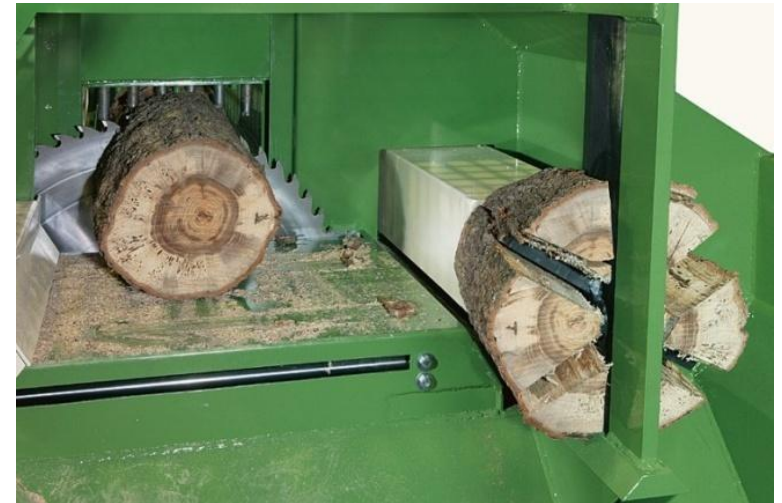
Foto 6: Ejemplo de línea combinada de serrado y astillado de leñas
