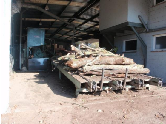
Foto 4: Transportadora de trozas en la entrada de una sierra
